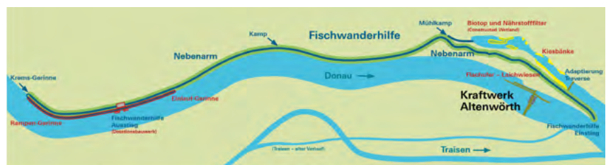
Rund um Altenwörth: Die 12,5 Kilometer lange, naturnahe Fischwanderhilfe sowie der Altarm der Donau, an dem ökologische Maßnahmen erfolgten.
